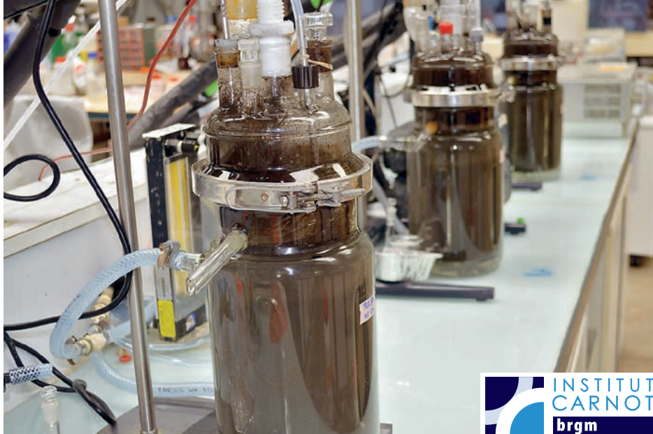
Banc de réacteurs batch pour l'étude des phénomènes physico-chimiques intervenant dans la biolixiviation des minerais sulfurés. © BRGM - Ménard
