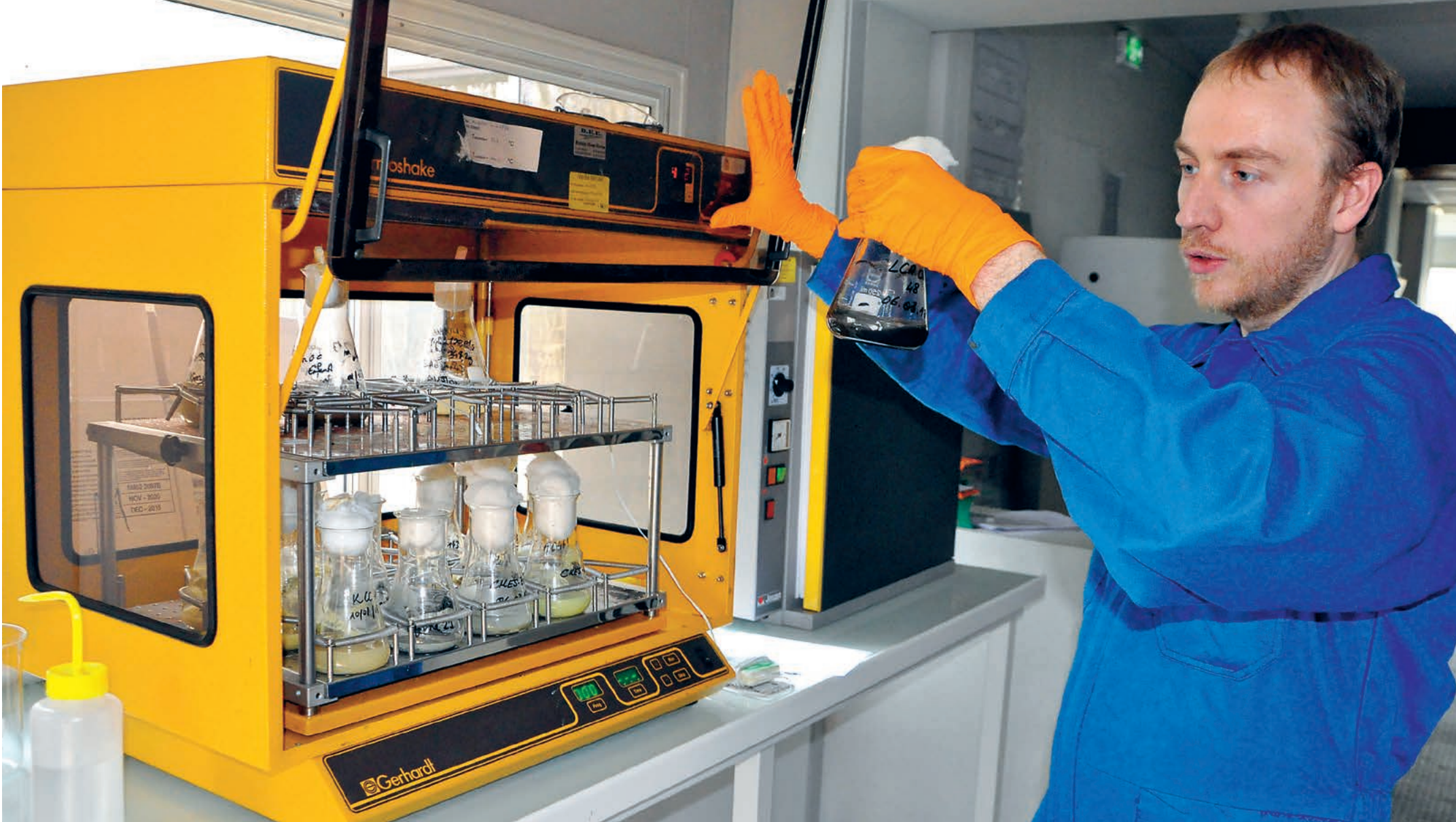
En vue des questionnements et des besoins sociétaux, le BRGM développe et optimise des processus de biolixiviation pour extraire des métaux. Exemple avec le projet Ecometals. © BRGM
