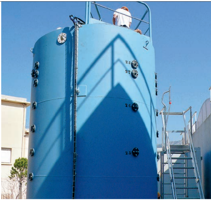
Le réacteur de suivi du pouvoir d'épuration des sols sur un pilote expérimental REUSE - Recyclage des eaux usées (gestion active des nappes en zone littoral). Ici une colonne de sol reconstituée avec infiltration d'eau usée traitée et monitoring par bougies poreuses (France, 2009). © BRGM
